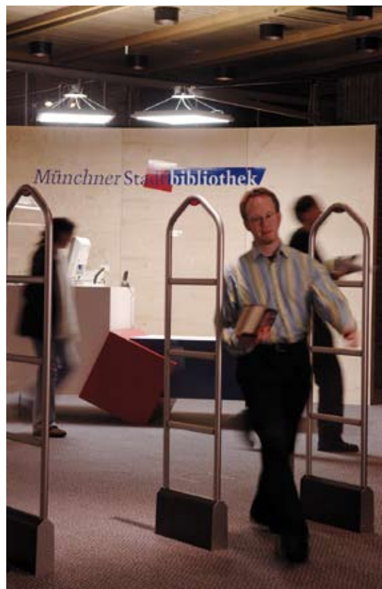
Das BiblioGate am Ausgang kontrolliert die korrekte Medienverbuchung.
